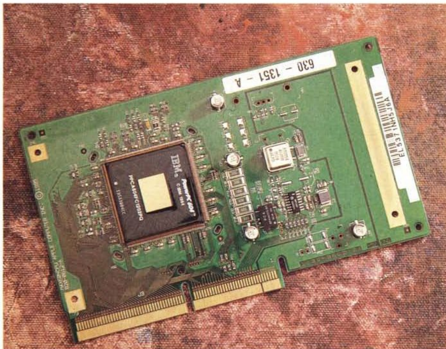
La scheda microprocessore senza la grossa aletta di raffreddamento.
